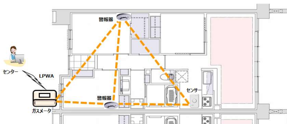
集合住宅でLPWA-NCUをGWとしてセンサネットワークを構成
