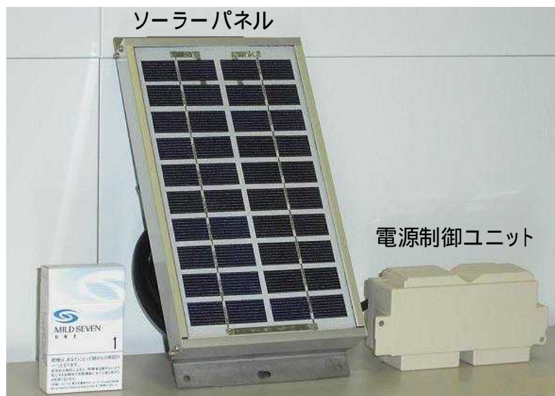
図1 ソーラー電源装置の外観
